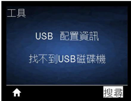
**說明：**可讓操作員傳送印表機設定報告 (發出 ZPL `^HH` 指令時，等於由印表機傳回主機系統的資料)。印表機將檔案 (OUTxxx.txt，其中 xxx = 000 至 999) 傳送至印表機 USB 主機連接埠的 USB 隨身碟並依據 [USB 主機連接埠](#) 和 [Link-OS 使用範例](#) 中提供的資訊進行格式化。印表機設定報告檔案名稱會隨每個寫入 USB 隨身碟的報告遞增 (OUT001.txt 遞增為 OUT002.txt，下次寫入檔案時)。
