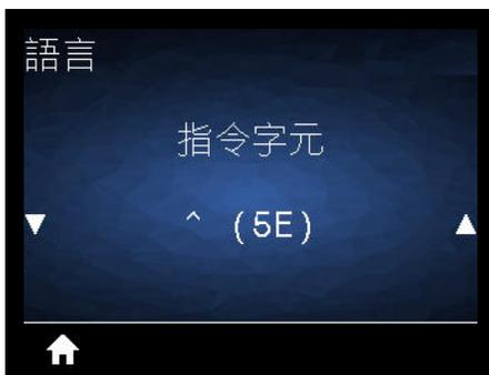
說明：此功能表用於變更格式指令字首。格式指令字首為 ASCII (以括號顯示的二位數十六位元值)，在 ZPL/ZPL II 格式指示中作為參數位置標記使用。印表機會尋找這個指令字元，以指出 ZPL/ZPL II 格式指示的開始處。
