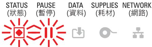
印字頭的溫度過高。**關閉印表機**。請等待數分鐘讓印表機完全冷卻，再開啟印表機。
