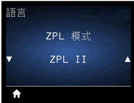
**說明：**選取符合標籤格式所使用的模式。印表機會接受以 ZPL 或 ZPL II 寫入的標籤格式，並避免重新寫入任何現存的 ZPL 格式之需求。印表機維持在已選取的模式，直到使用其中一種此處所列的方法變更模式為止。
