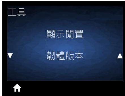
**說明：**選取印表機閒置時顯示的六種資訊格式之一。未隨所有設定顯示。
