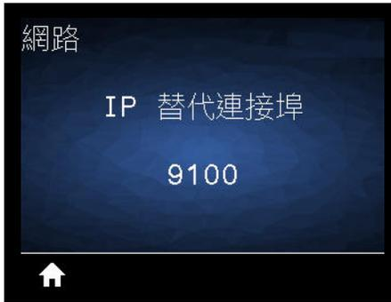
**說明：**此指令可設定替代 TCP 連接埠的連接埠號碼。
