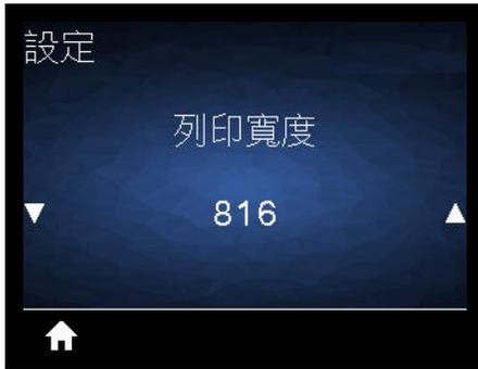
**說明：**以點數指定使用中標籤的寬度。根據印字頭的 DPI 值，預設值是印表機的最大寬度。
