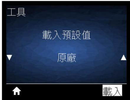
**說明：**將特定印表機、列印伺服器和網路設定回復為原廠預設值。載入預設值時請小心謹慎，因為您需要重新載入以手動方式變更的所有設定。您可透過兩個使用者功能表使用此功能表項目，每個功能表都具有不同的預設值。
