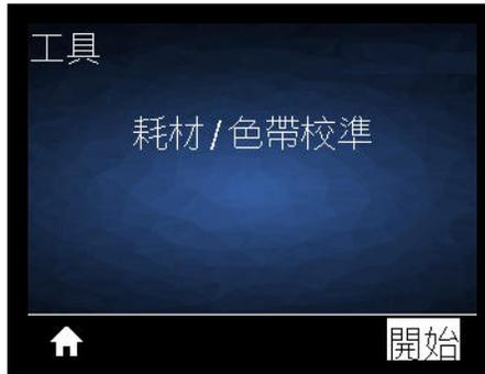
說明：校準印表機以調整耗材感應器的敏感度。
