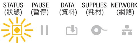
印字頭的溫度過低。一般而言，是指作業環溫度低於印表機的最低作業溫度。
