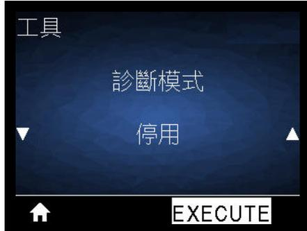
說明：使用此診斷工具，可讓印表機以十六進位值輸出所接受的全部資料。如需詳細資訊，請參閱 [通訊診斷測試](#)。
