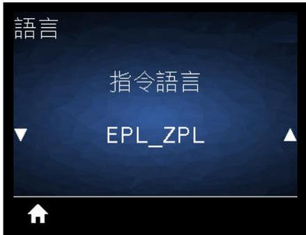
說明：此設定可讓您控制主要程式設計語言變化，例如 EPL\_ZPL、EPL (舊有語言) 及 Hybrid\_XML\_ZPL (用於以 XML 結構元素填入格式/表格變數)。
