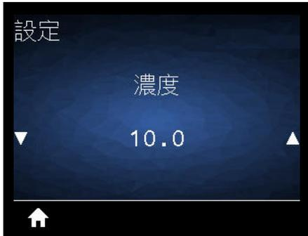
**說明：**將列印濃度設定為足以提供良好列印品質的最低設定值。如果將濃度設得太高，標籤影像可能無法清楚列印、條碼可能無法正確掃描、色帶可能腐蝕且印字頭可能提早磨損。
