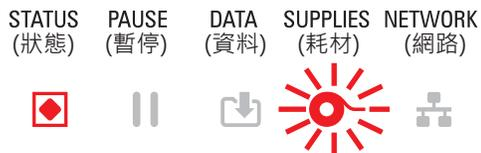
當印表機為熱轉印模式時，偵測到色帶捲筒結尾 (色帶捲筒的反光端)、缺少色帶托架，或需要更換色帶托架才能繼續列印。
