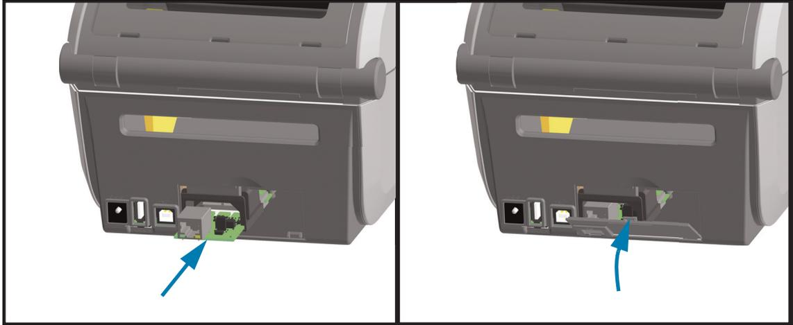
1. 透過移除直流電電源插頭與模組檢修門，讓乙太網路模組滑入印表機。緩慢且穩定推入電路卡，直到電路卡剛好通過檢修門內側為止。
