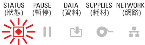
印表機無法判讀印字頭解析度類型 (dpi)。未正確更換印字頭或更換的非 Zebra 印字頭。
