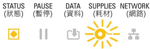
熱轉印印表機為熱感應模式，並已安裝色帶托架。移除色帶托架可繼續以熱感應模式列印。
