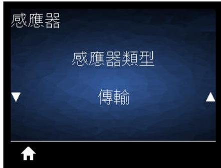
**說明：**選取適合您正在使用之耗材的耗材感應器。反射感應器通常僅用在黑色標記耗材上。傳輸感應器通常用於其他耗材。
