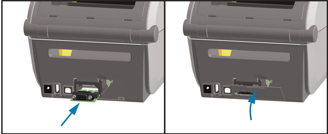
1. 透過移除直流電電源插頭與模組檢修門，讓序列埠模組滑入印表機。緩慢且穩定推入電路卡，直到電路卡剛好通過檢修門內側為止。
