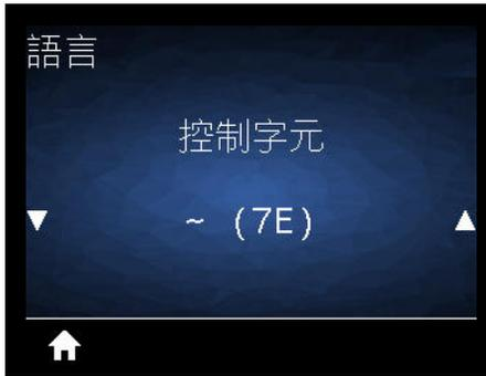
**說明：**此功能表用於變更控制指令字首。預設字首為鼻音符號 (~)。印表機會尋找這個字元以指出 ZPL/ZPL II 指令的開始處。設定格式字首字元以符合您標籤格式所使用的字元。
